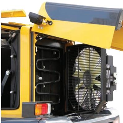
O radiador, o pós arrefecedor ar/ar e o resfriador do óleo são montados lado-a-lado para maior eficiência no arrefecimento e facilitação da limpeza. Uma máscara traseira assistida por amortecedor a gás proporciona ao operador excepcional acesso ao ventilador articulado e aos resfriadores.
