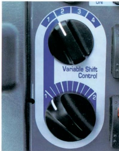
O interruptor de mudança de velocidades variável possibilita ao operador ajustar a velocidade de sua máquina em carregamento em "V" executado em espaços confinados. Na posição 1, o operador pode ajustar, mediante o emprego do interruptor de mudança de velocidade variável, a velocidade de deslocamento que otimize à combinação perfeita da velocidade de sua máquina e o sistema hidráulico com a distância a ser percorrida.
